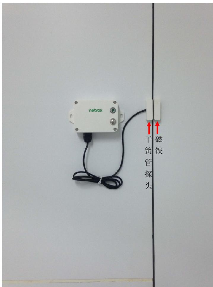
安装设备时，磁铁必须相对于传感器沿 X 轴移动
